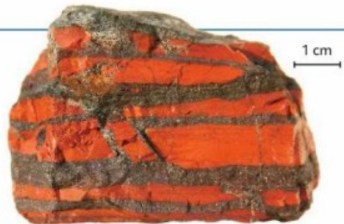
Échantillon de fer rubané Bancs gris d'hématite ( Fe_2O_3 ) Bancs rouges de silice, avec des traces d'hématite
