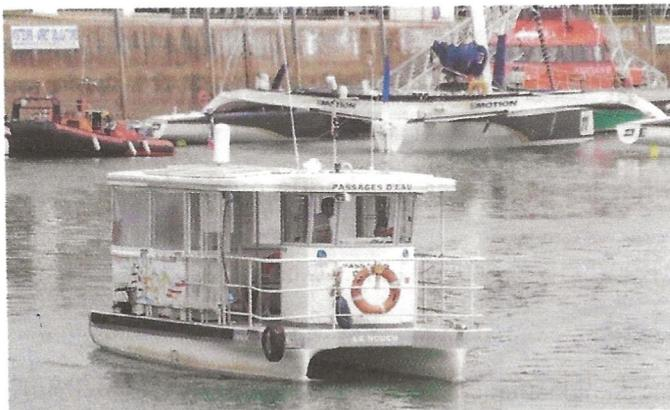
Pour limiter l'utilisation de la voiture, la ville des Sables d'Olonne utilise des navettes maritimes électriques « zéro émission ». Le choix de la technologie « lithium fer phosphate » pour les batteries, combiné à une installation photovoltaïque à haut rendement, procure une autonomie suffisante pour effectuer une journée de service sans recharge.
